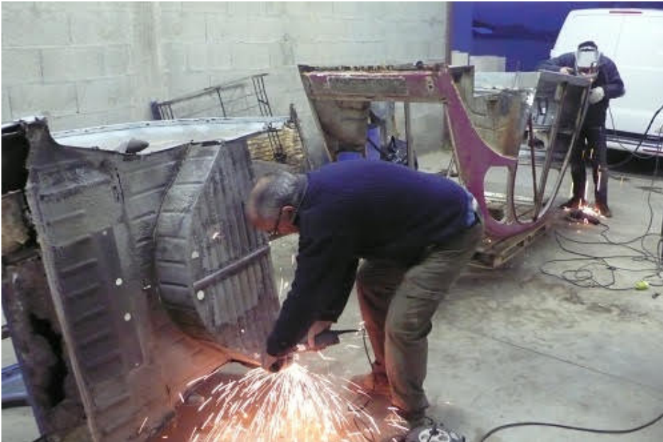
Là on cannibalise la deuxième caisse pour renforcer la première
