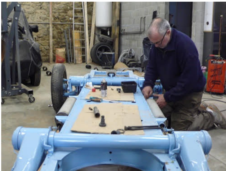
Enfin mise en place des pots. Et c'est les bonnes hauteurs
