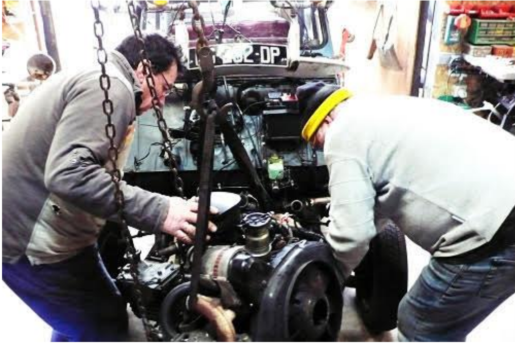
On sort le moteur qui fera la course, enfin rodé, de la 2cv qui a fait le mulet.
