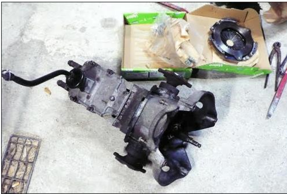
Idem pour la boîte à vitesse, car une fois tout le bazar par terre, autant changer l'embrayage.
